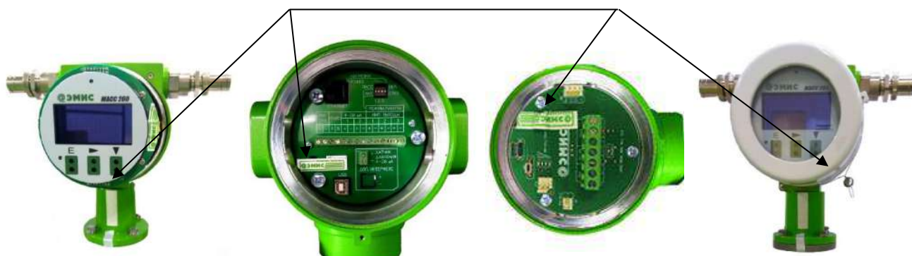
Рисунок 1.5 Варианты пломбирования счетчиков-расходомеров "ЭМИС-МАСС 260", в зависимости от исполнения электронного блока.
